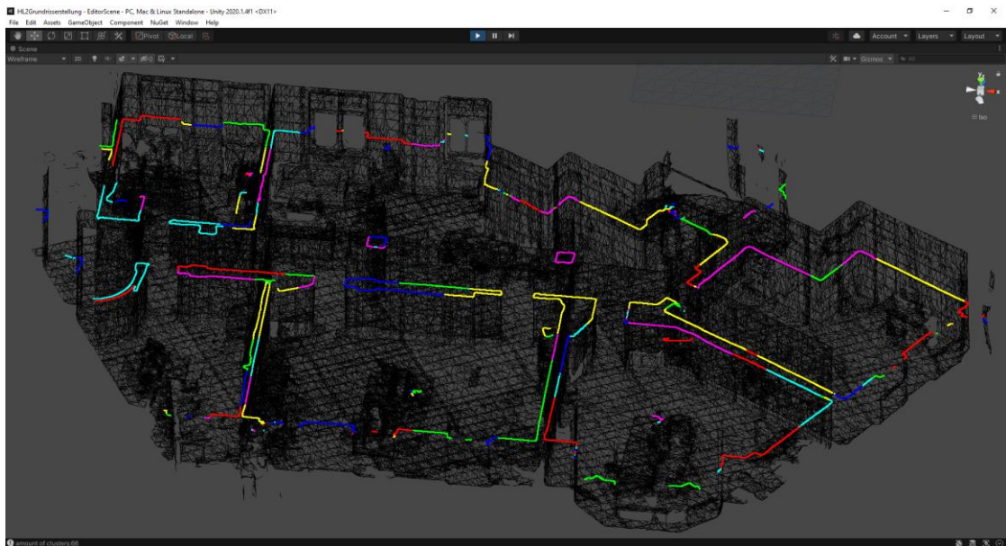
Abbildung 14: Unterteilung der ermittelten Querschnittkanten in zusammenhängende Kantenabschnitte.
