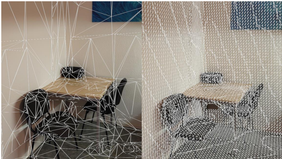
Abbildung 7: Vergleich der Polygonnetze des Systems zur räumlichen Abbildung (links) und des Szenenverständnis-Systems (rechts).
