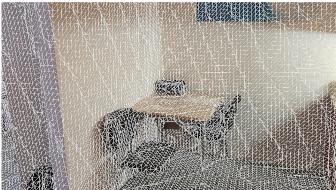
Abbildung 4: Über der Umgebung liegendes Polygonnetz des Szenenverständnis-Systems.
