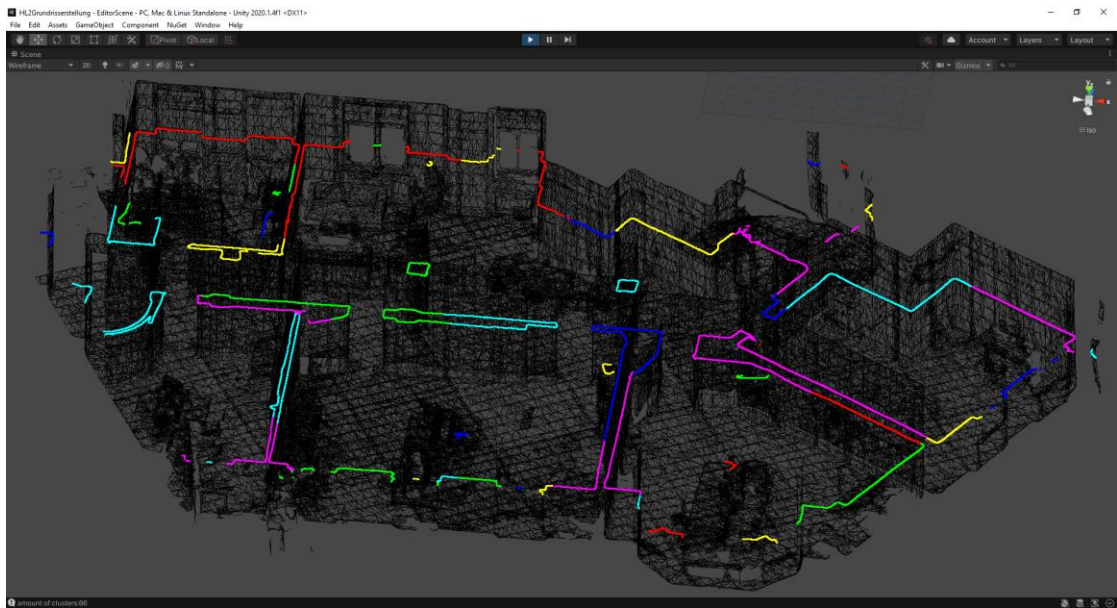
Abbildung 15: Zusammenfassung ermittelter Kantenabschnitte deren Enden nah beieinander liegen. Erzielte in diesem Fall zur Verringerung der Abschnittszahl von 189 auf 66.
